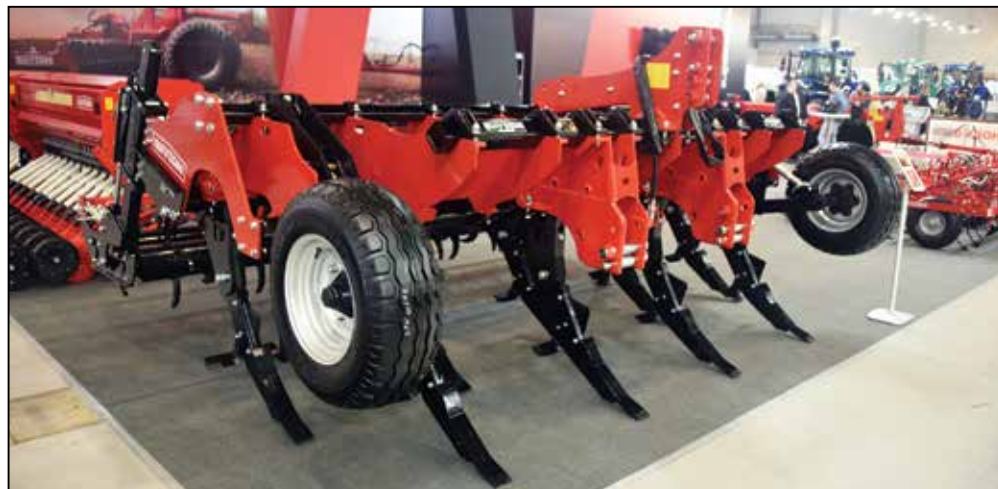
Двухрядный глубококорыхлитель SSDR 9/400 рассчитан на интенсивное применение в условиях повышенной нагрузки
