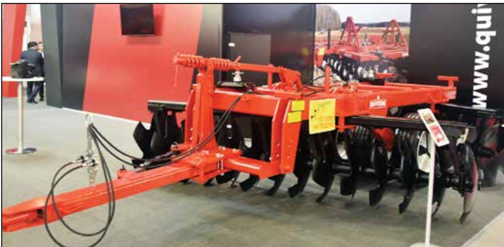
Тяжелая дисковая борона APFL FF M 28 «Флео-Флео» отличается продуманной конструкцией и высокой прочностью
