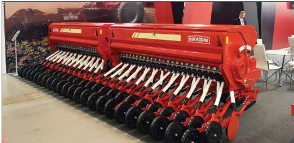
Механическая зерновая сеялка Q-Drill 600 G Combi сочетает надёжность с точной работой высевочных аппаратов
