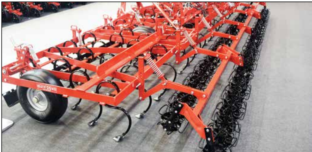
Предпосевной культиватор Turbocombinator L разрабатывался как многофункциональное орудие, способное выполнять несколько операций за один проход
