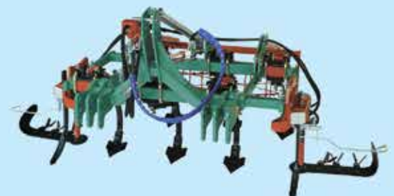
Культиватор CLEMENS TERACTIV с приспособлениями для межствольной обработки почвы
