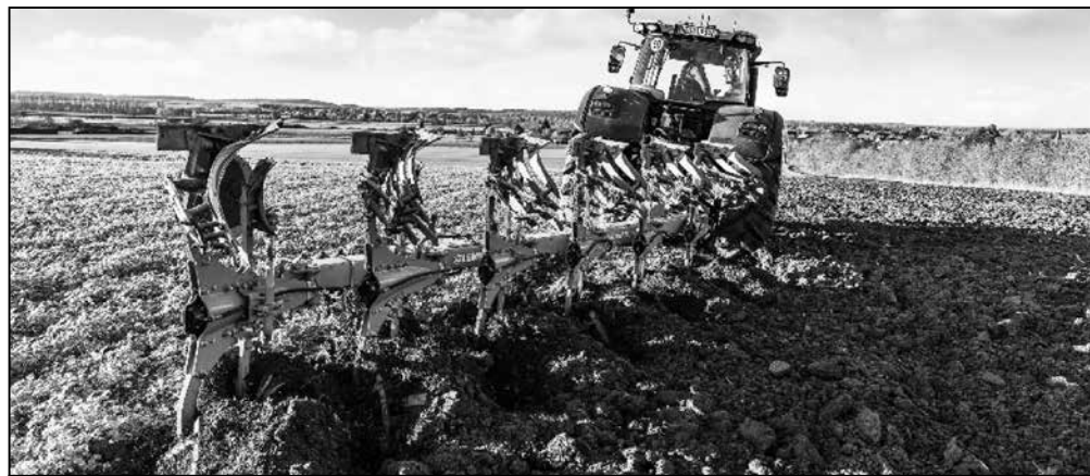
Навесной полнооборотный плуг Jewel 10 с системой защиты от перегрузок OptiStone
