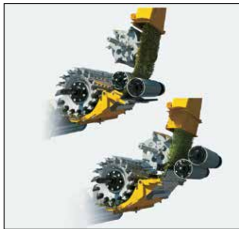
Система подачи урожая в прицеп имеет один параметр для кукурузы и два - для травы
