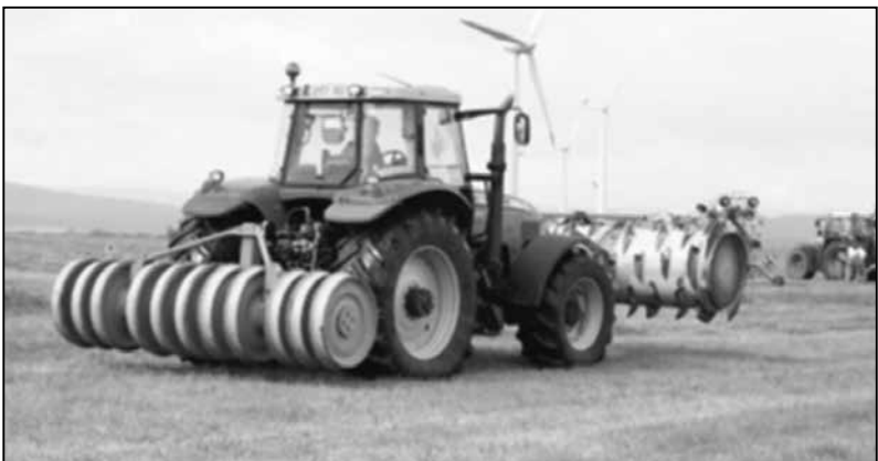
Фото 4. Использование переднего и заднего НУ для ускорения темпа трамбовки
