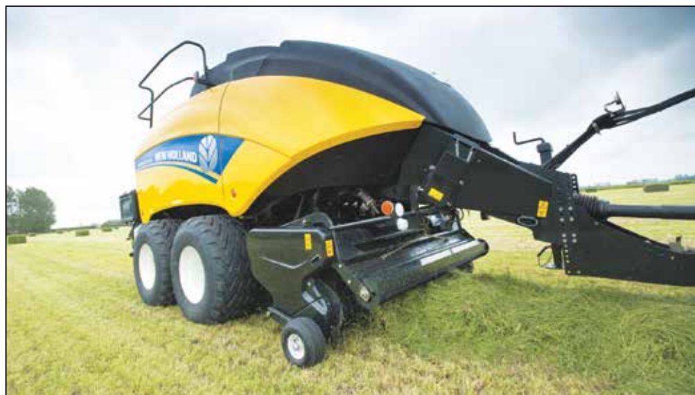
Новый крупнопакующий пресс-подборщик BigBaler 1290 способен произвести до 110 тюков в час
