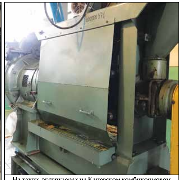
На таких экструдерах на Каневском комбикормовом заводе готовятся экструдированная соя, соевый жмых и соевое масло для комбикормов
