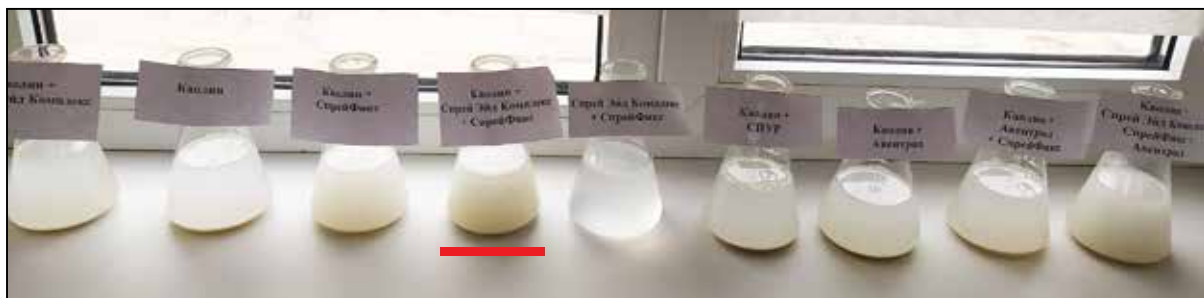
Красной чертой отмечен раствор каолина со Спрей Фиксом, который в лабораторных условиях сохранял стабильность в течение суток без образования осадка
