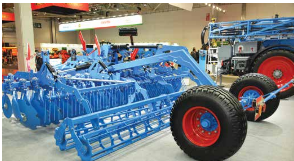
Короткая дисковая борона Rubin 10 даже в сложных условиях обеспечивает интенсивное и однородное перемешивание органической массы и почвы
