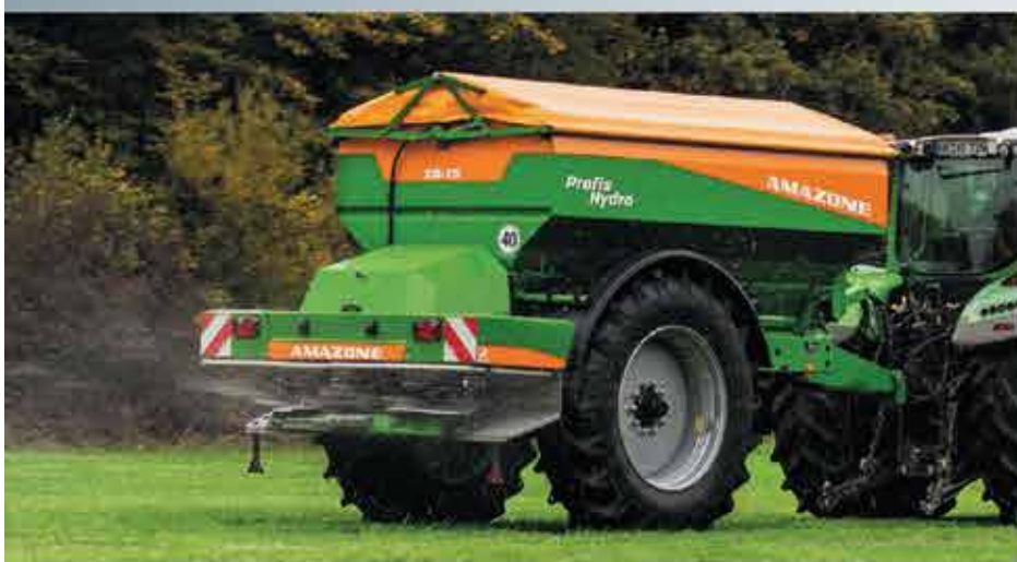
ZG-TS и ZA-TS от AMAZONE с многократным посекционным включением DynamicSpread
