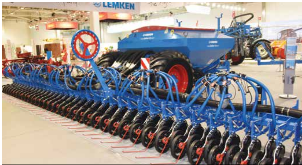
Прицепная пневматическая рядовая сеялка Solitair 12 с шириной захвата от 8 до 12 м отличается высочайшей производительностью и экономичностью
