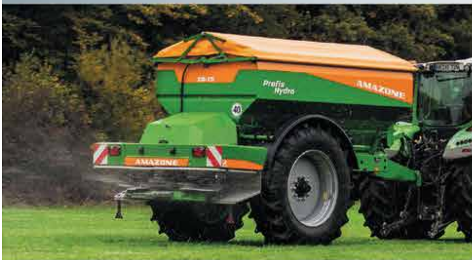
ZA-V с гидравлической регулировкой заслонок
