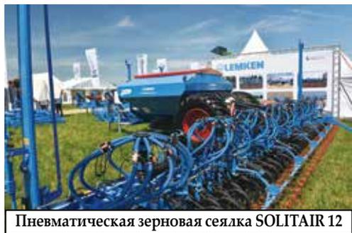
Пневматическая зерновая сеялка SOLITAIR 12
