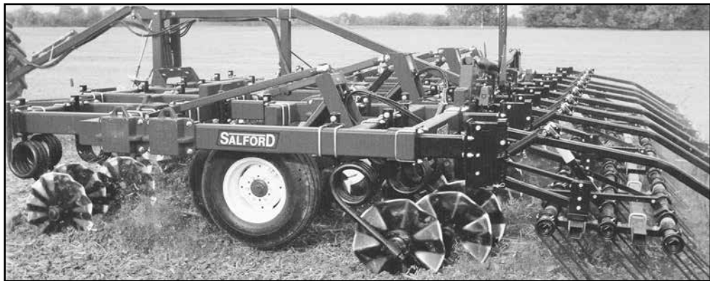
Фото 2. Турбокультиватор RTS — специалист по обработке растительных остатков. Механизм вертикальной обработки почвы
