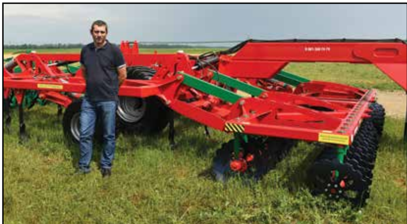
Агрегат диско-лаповый АДЛ-6 за один проход выполняет несколько операций
