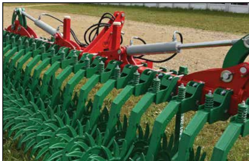
Борона ротационная БРИ-6 отличается высокой производительностью
