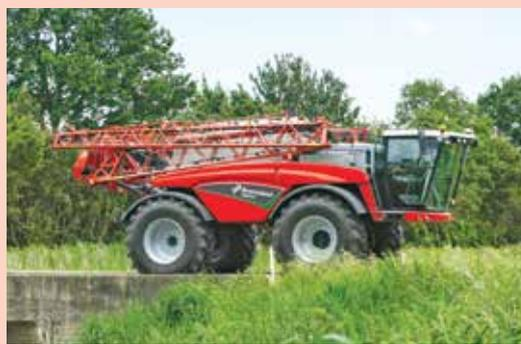
**Прицепные, навесные и самоходные опрыскиватели** - объем бака от 1100 до 6000 литров. Штанга стальная или алюминиевая, от 12 до 42 метров. Отличное копирование штангой рельефа обрабатываемого поля.
