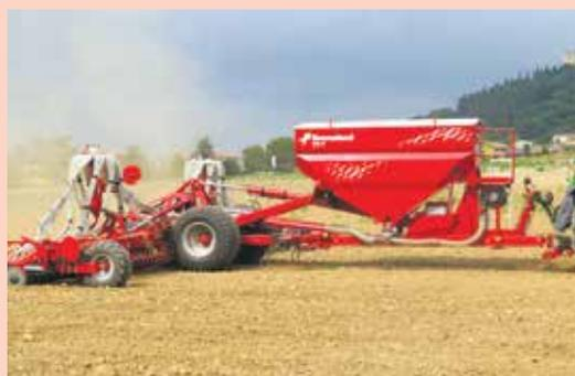
**Пневматические зерновые сеялки** с шириной захвата от 4 до 12 метров, электрическим дозирующим устройством, дисковыми сошниками. Высокая скорость и непревзойденное качество высева.
