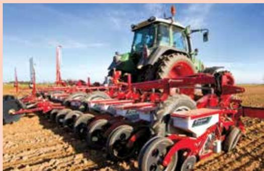
**Сеялка monopill** - знаменитая немецкая сеялка для сева сахарной свеклы, количество рядов от 12 до 24, механический или электрический привод высевающего механизма. Низкая высота падения семян от высевающего диска, самая точная расстановка семян.
