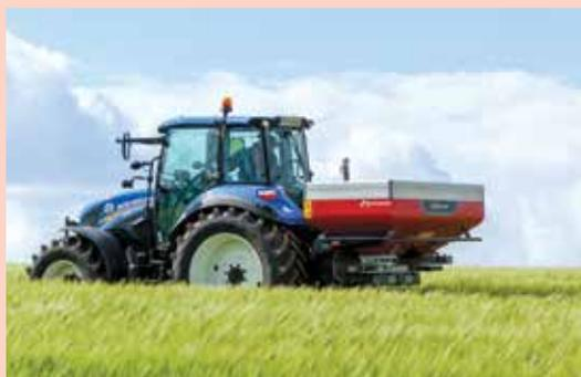
**Разбрасыватели минеральных удобрений** – объем бункера от 900 до 3950 литров, ширина разбрасывания от 18 до 42 метров. Запатентованная система разгона материала, предотвращающая повреждение семян и гранул.
