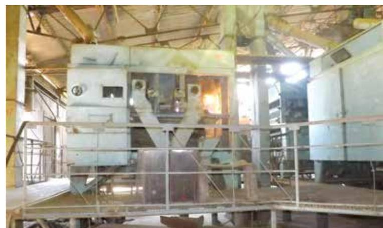
Зерноочистительная машина K-527 очищает зерно при помощи воздушных потоков
