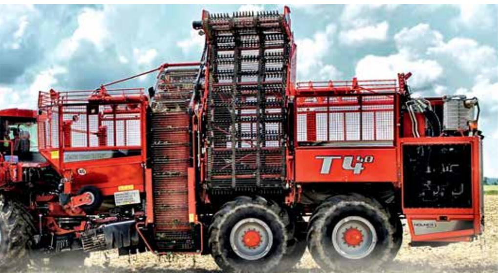
тельное время. На втором и на заднем третьем мостах установлены 1050/50 R32 шины, которые имеют давление 2 атмосферы. Нагрузка на заднюю ось гидравлически управляема, что дает идеально сбалансированное распределение веса на все оси и, как следствие, равномерное почвозащадящее уплотнение земли.
