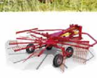
Гребли ротационные навесные КОЛИБРИ 350/470 ширина захвата 4,7 м, производительность до 5,4 га/ч
