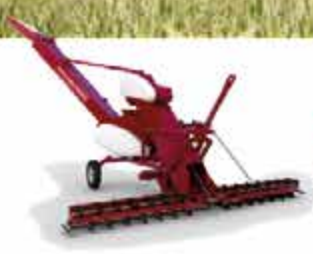
Метатель зерна самоперевалочной МЭС-90 высота выгрузки до 3,4 м, поворот тринера до 135°
