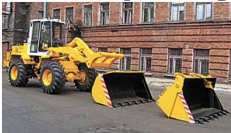
Универсальный погрузчик АМКОДОР 332С4-01 приспособлен для работы в сельском и коммунальном хозяйстве, в гражданском и дорожном строительстве
