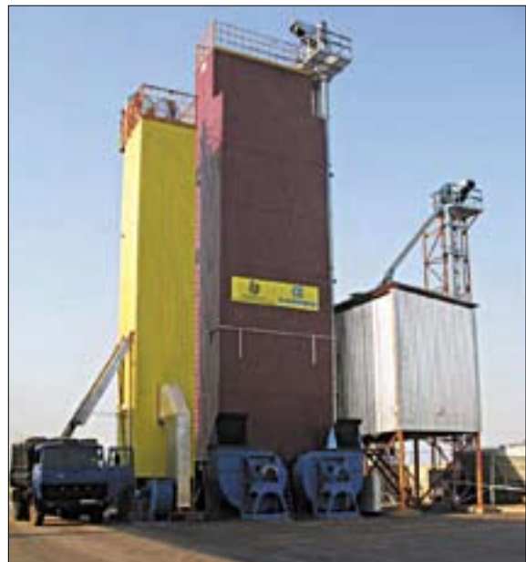
Зерноочистительно-сушильный комплекс ЗСК-30 обеспечивает комплексную механизацию сушки, очистки, погрузочно-разгрузочных работ
