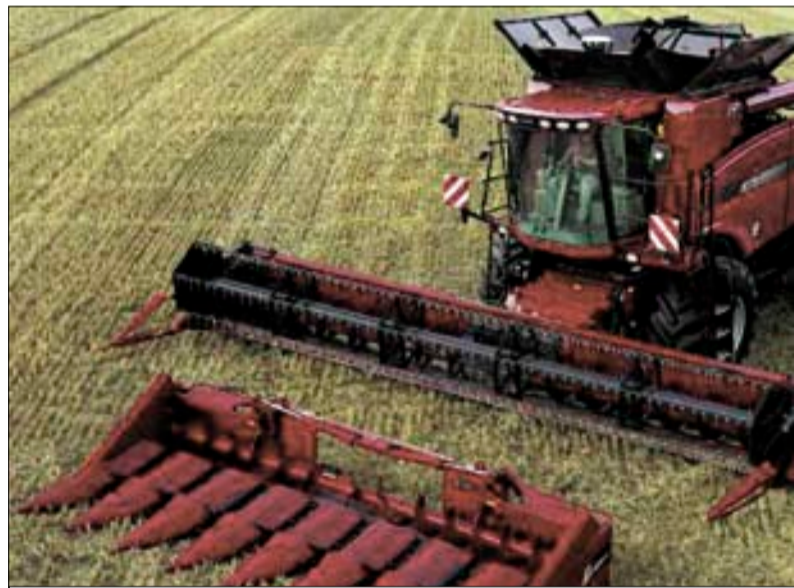
Комбайн компании Case IH Axial Flow 9120 комплектуется 8- и 12-рядными кукурузными жатками
