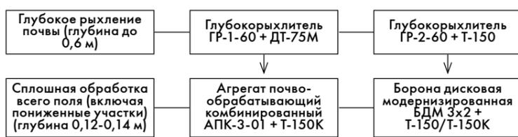
одноножевыми ГР-1-60 или двухножевыми ГР-2-60 на глубину до 0,6 м. Расстояние между проходами агрегата для обеспечения хорошего отвода воды должно быть в пределах 1,8 – 2,0 м (рис. 1).
