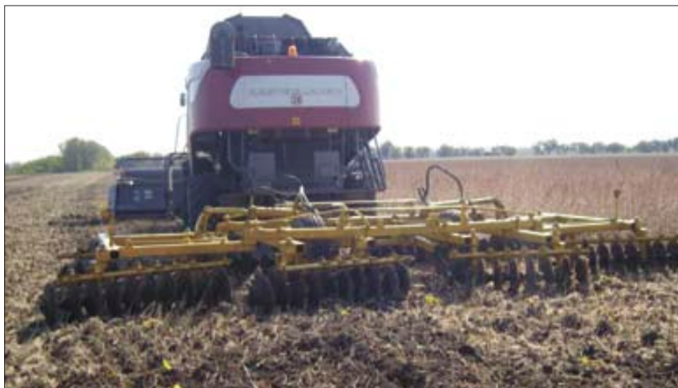
Многофункциональный уборочно-почвообрабатывающий агрегат на уборке сои
