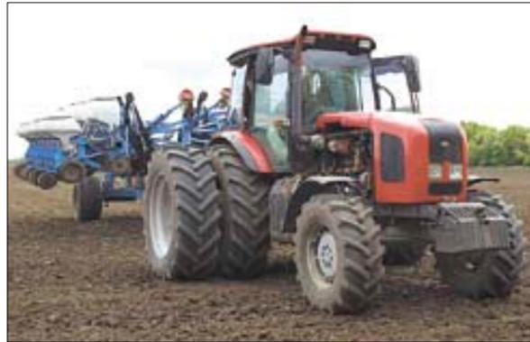
Сеялка Monosem на раме Kivoni, агрегатированная с трактором «Беларус-2022»
