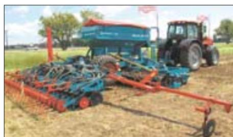
Трактор «Беларус 2522» агрегатированный с сеялкой MAXIDRILL TRW
