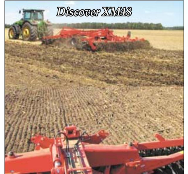
Уникальная конструкция с хребтовой рамой обеспечивает равномерную обработку по всей ширине захвата, изменение угла атаки независимо от глубины. Установленный сзади эксклюзивный каток T-Ring roller работает и в сухой, и во влажной почве с качественным выравниванием и крошением без забивания и с регулируемым давлением.
