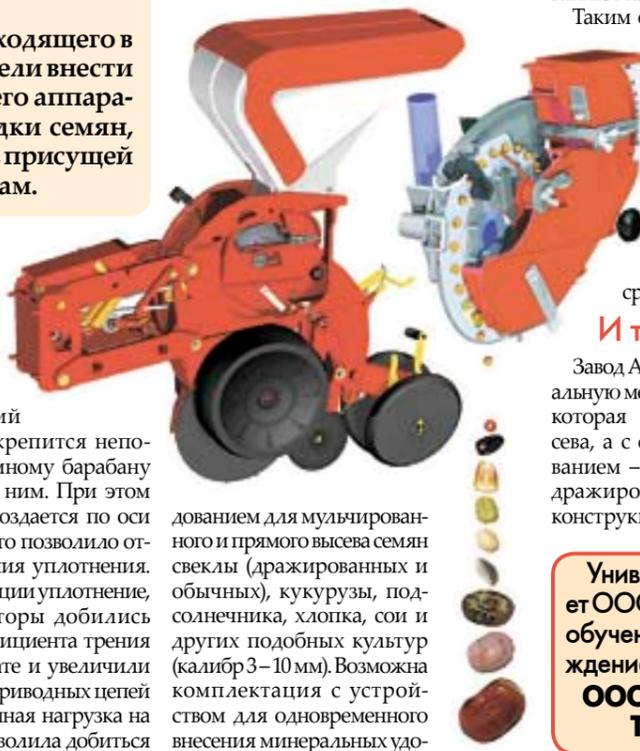
давлением для мульчированного и прямого высева семян свеклы (дражированных и обычных), кукурузы, подсолнечника, хлопка, сои и других подобных культур (калибр 3–10 мм). Возможна комплектация с устройством для одновременного внесения минеральных удо-
