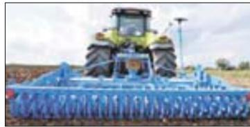
«Циркон-8», предназначенную для оптимальной предпосевной обработки почвы. Это новая модель для тракторов мощностью от 60 до 175 л. с. Ее особенность – простая концепция с дополнительными комплектующими для оснастки агрегата в соответствии с полевыми условиями. Имеется в виду широкий выбор модулей редуктора и крепления ножей, а также утяжеленная башня, центрально регулируемая планировочная балка и большой ассортимент катков.
