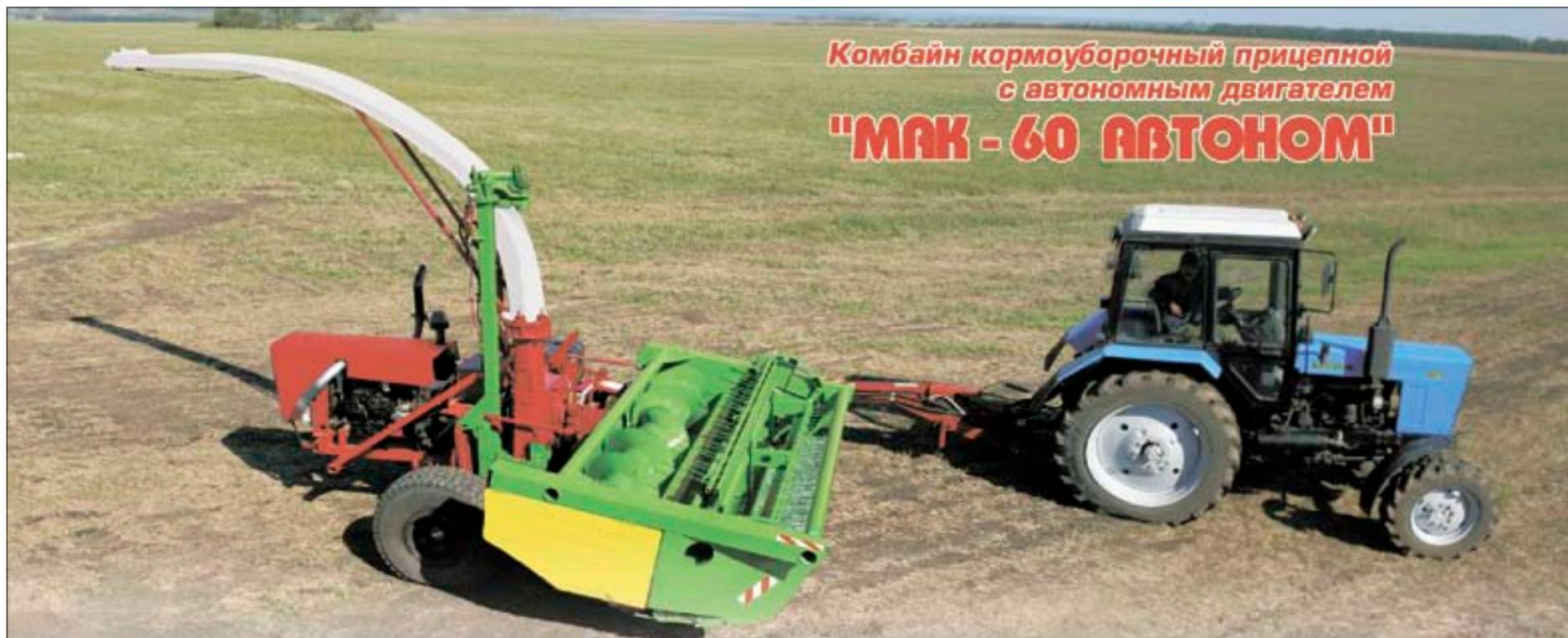
Средняя производительность комбайна в зависимости от вида массы: 40 - 60 тонн в час измельченной массы.
