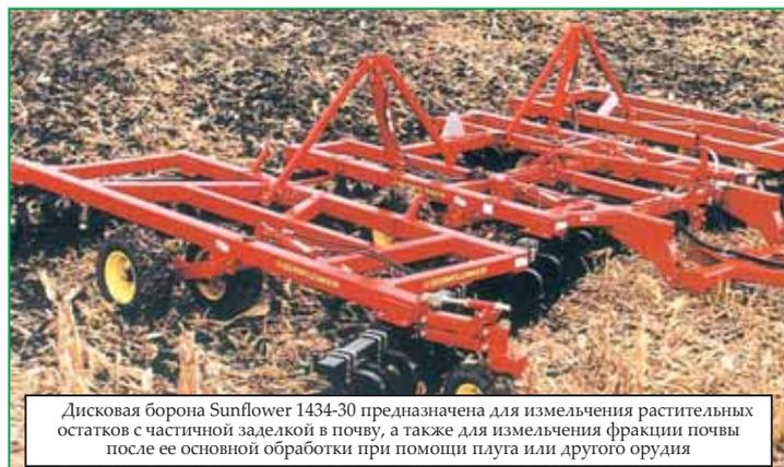
Дисковая борона Sunflower 1434-30 предназначена для измельчения растительных остатков с частичной заделкой в почву, а также для измельчения фракции почвы после ее основной обработки при помощи плуга или другого орудия
