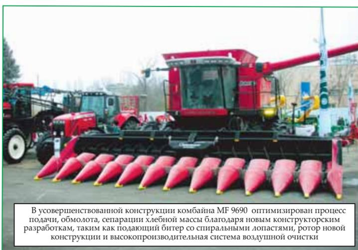
В усовершенствованной конструкции комбайна MF 9690 оптимизирован процесс подачи, обмола, сепарации хлебной массы благодаря новым конструкторским разработкам, таким как подающий битер со спиральными лопастями, ротор новой конструкции и высокопроизводительная система воздушной очистки
