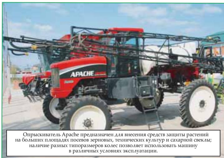
Опрыскиватель Apache предназначен для внесения средств защиты растений на больших площадях посевов зерновых, технических культур и сахарной свеклы; наличие разных типоразмеров колес позволяет использовать машину в различных условиях эксплуатации.
