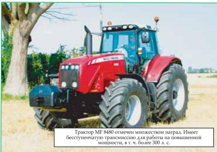
Трактор MF 8480 отмечен множеством наград. Имеет бесступенчатую трансмиссию для работы на повышенной мощности, в т. ч. более 300 л. с.
