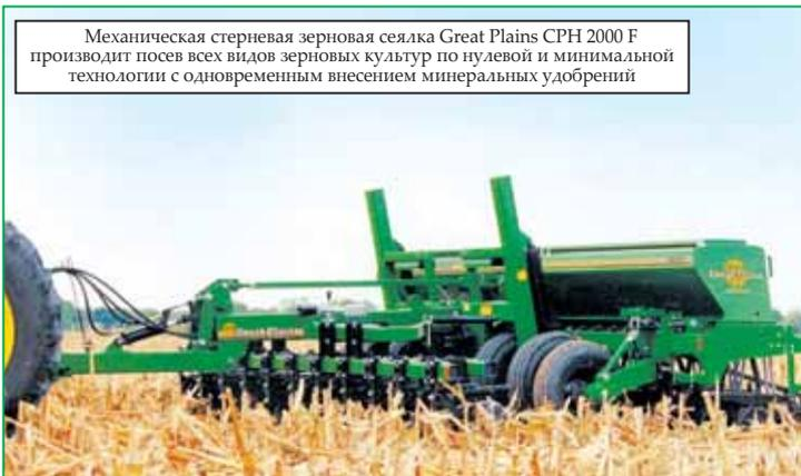
Механическая стерневая зерновая сеялка Great Plains CPN 2000 F производит посев всех видов зерновых культур по нулевой и минимальной технологии с одновременным внесением минеральных удобрений
